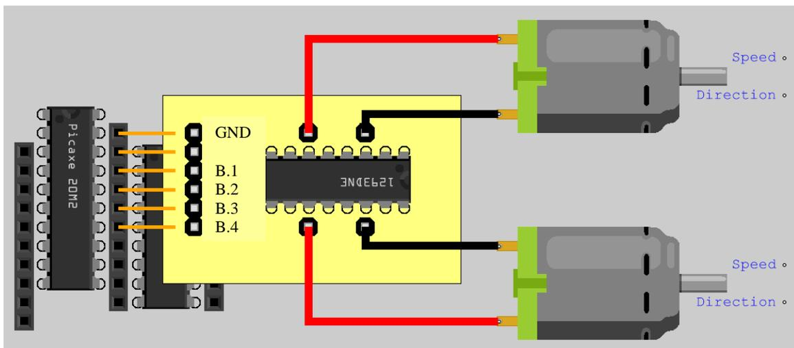
Zum Steuern der Motoren des GSR-Kettenfahrzeugs brauchen wir die Pins B.1 bis B.4, die jeweils eine Verbindung zu den IC-Pins 1A, 2A, 3A und 4A haben. Schaltet man die Pins B.1 und B.4 auf High und die Pins B.2 und B.3 auf low, dann fährt das Fahrzeug vorwärts.
