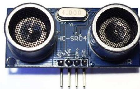
Um den HC-SR04 benutzen zu können, muss die interne Geschwindigkeit des Picaxe-20M2-Mikrokontrollers mit dem Befehl *setfreq M8* von 4 Mhz auf 8 Mhz erhöht werden. Somit muss auch die Baudrate des Terminalfensters verdoppelt werden (von 4800 auf 9600).
