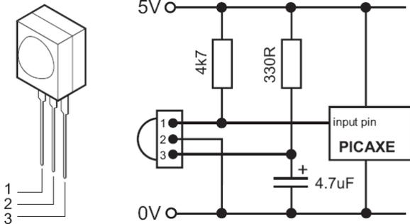
Das nachfolgende Schaltbild zeigt, wie der Infrarotsensor LED020 an unser Projektboard angeschlossen werden muss. Auf der Homepage von Picaxe findet man auch ein Schaltbild ohne den 330-Ohm-Widerstand. Tests haben ergeben, dass die Schaltung auch ohne den Widerstand funktioniert.
