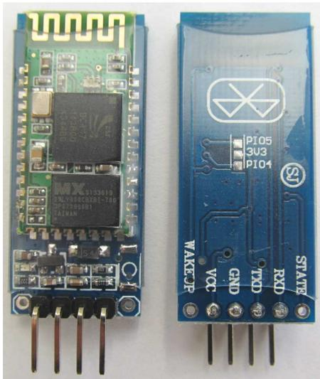
Den HC-06 kann man mit backplane (wichtig) über ebay, banggood, aliexpress oder andere Portale erwerben. Das eigentliche HC-06 Bluetooth Modul ist mit einer blauen Adapterplatte (backplane) verbunden und kann wegen eines Spannungsreglers mit 3,3V bis 6V Spannung versorgt werden. Der HC-05 kann als Master (senden und empfangen) und der HC-06 nur als Slave (empfangen) arbeiten.
