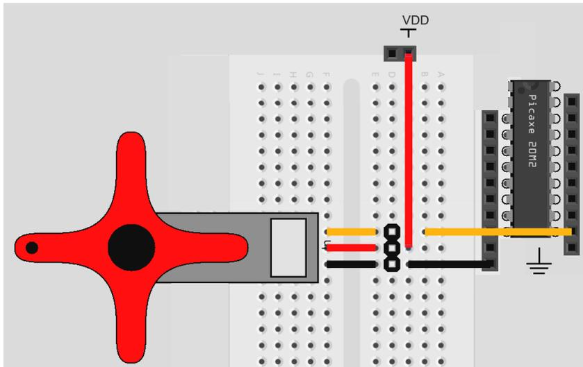
Um Servos steuern zu können, muss man sie richtig an das GSR-Picaxe-20M2-Projektboard anschließen. Das orangene Kabel ist die Signalleitung, die an einen B-Pin angeschlossen werden muss. Rot ist die Spannungsversorgung (5V) und schwarz die Masse (0V).
